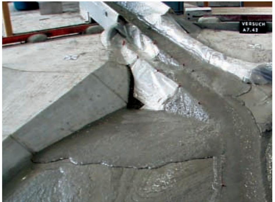
**Abb. 2: Geschiebesammler Maschänserrüfe: Transportgerinne durch den Sammler, seitliche Entlastung von Murgangmaterial zur Begrenzung des Ausflusses (Modellmassstab 1:60).**
